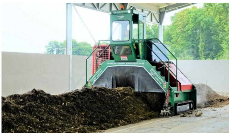
Slika 2.4. Strojno mehaničko okretanje windrow sustava. 56
