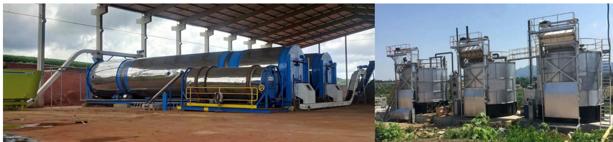
Slika 2.6. Reaktorski sustavi: a) horizontalni (lijevo) 62 , b) vertikalni (desno) 63 .
