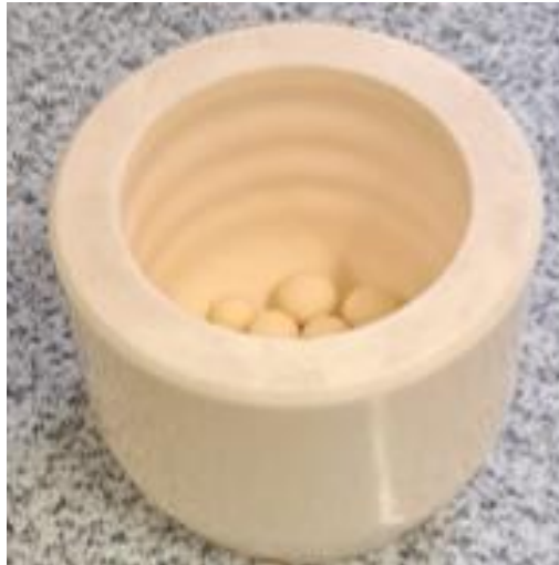
Slika 12. Fotografija korundne posude i tijela za usitnjavanje
