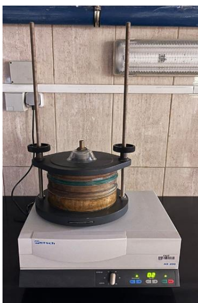
Slika 15. Fotografija uređaja za potresivanje sita AS 200 (Retsch GmbH, Haan, SR Njemačka).
