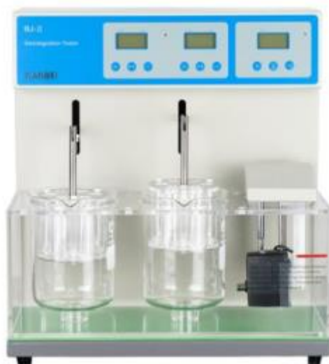
Slika 21. Fotografija uređaja za ispitivanje raspadljivosti tableta BJ 2 (Zhengzhou Nanbei Instrument, Henan, NR Kina) 55
