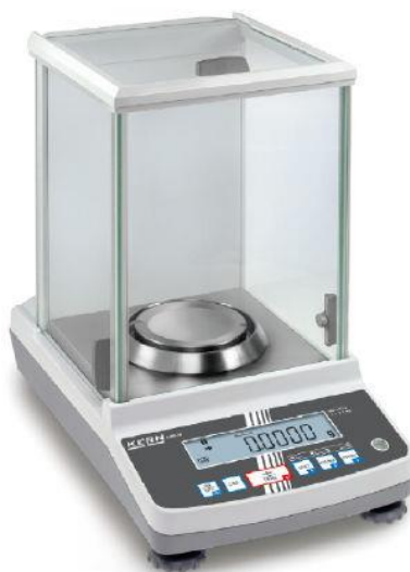
Slika 19. Fotografija analitičke vage ALJ 220-4NM (KERN, Balinge, SR Njemačka). 52
