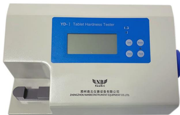
Slika 20. Fotografija uređaja za određivanje čvrstoće tableta YD – 1 (Zhengzhou Nanbei Instrument, Henan, NR Kina) 53
