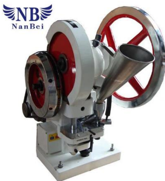
Slika 18. Fotografija uređaja za tabletiranje TDP-5T (Zhejiang Wisely Machinery Co., Ruian, NR Kina). 51
