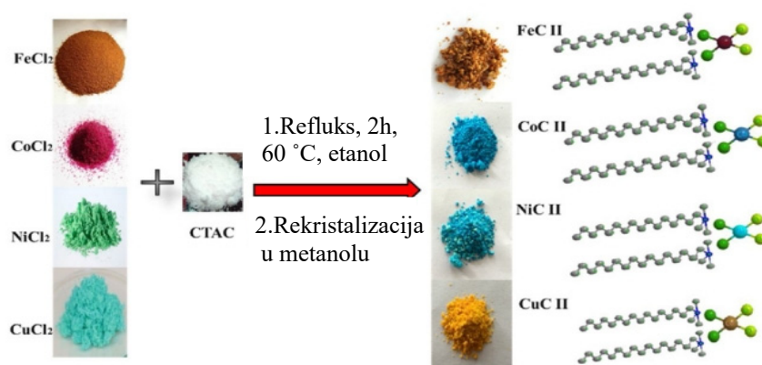
Slika 9. Shematski prikaz sinteze M-PAT (M = Fe, Co, Ni, Cu) iz heksadeciltrimetilamonijeva bromida (CTAC). Konstruirano prema referenci. 3
