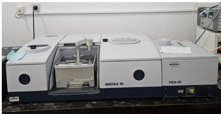
Slika 24. Prikaz korištenog FTIR spektrometra.
