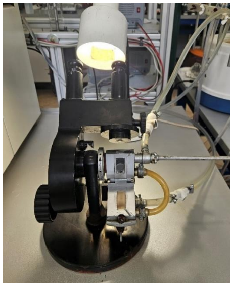
Slika 22. Refraktometar, Carl Zeiss Abbe refractometer. Jena, Germany
