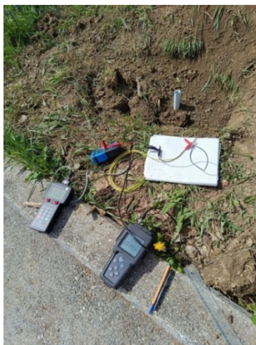
Slika 19. Mjerenja provedena vani sa zemljom kao ispunom Lugginove kapilare i elektrolitom u koji je postavljen mjereni sustav pri katodnoj zaštiti žrtvovanom anodom (mjerenja u kojima se pratila ovisnost uklanjanja IR komponente o duljini Lugginove kapilare)
