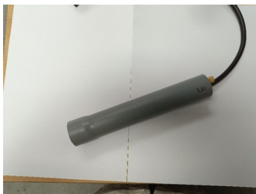
Slika 24. Treći primjer industrijski korištenog IR-free kupona
