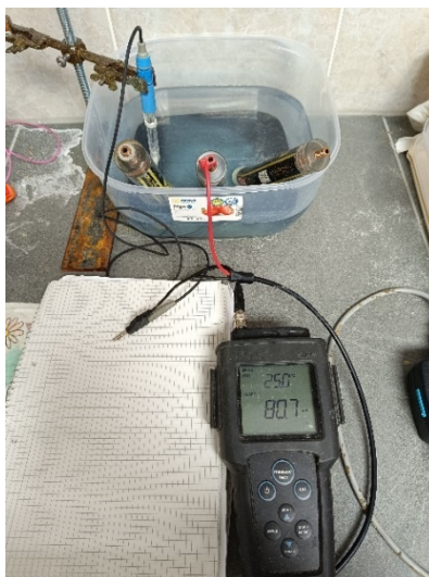
Slika 20. Primjer umjeravanja komercijalne prijenosne referentne elektrode s laboratorijskom kalomel referentnom elektrodom
