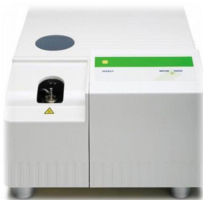
Slika 15. Fotografija diferencijalnog pretražnog kalorimetra Mettler Toledo 822e (Mettler Toledo GmbH, Greifensee, Švicarska)
