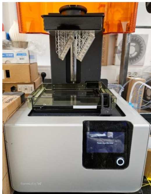
Slika 30. Modeli 3D-ispisanih reaktora s potpornim stukturama nakon završetka ispisa u SLA pisaču
