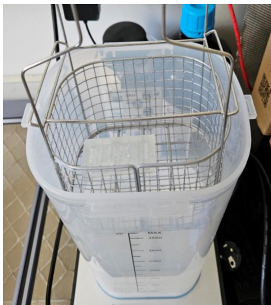
Slika 31. Ispiranje reaktora u izopropanolu
