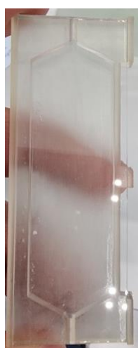
Slika 33. 3D-ispisan reaktor tehnologijom SLA od materijala High Temp (Formlabs) (reaktor smanjenog volumena)
