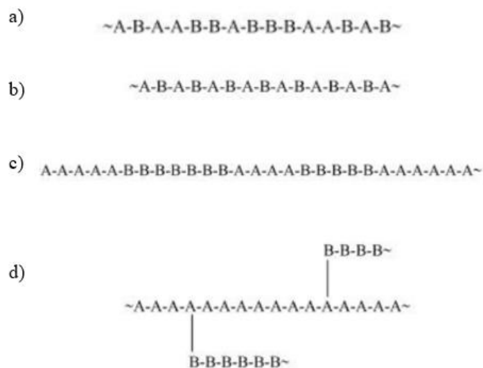
Slika 3. Shematski prikaz statističkih (a), alternirajućih (b), blok (c) i cijepljenih (d) kopolimera 13
