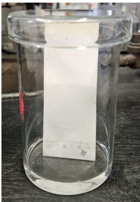
Slika 43. Korišteni TLC sustav
