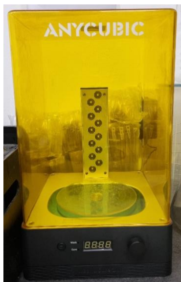
Slika 20. Komora za naknadnu obradu Wash & Cure Machine 2.0 (Anycubic)
