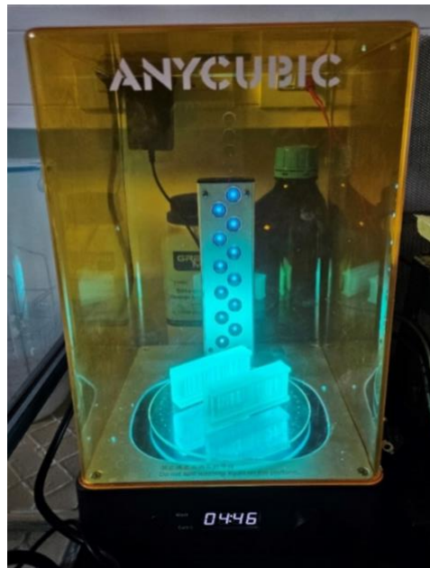
Slika 34. Modeli reaktora izloženi svjetlosti valne duljine 405 nm u komori za naknadnu obradu Wash & Cure 2.0 (Anycubic)
