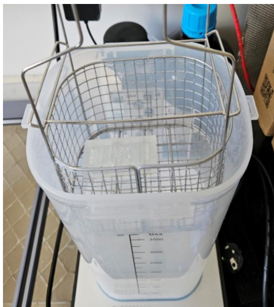
Slika 31. Ispiranje reaktora u izopropanolu
