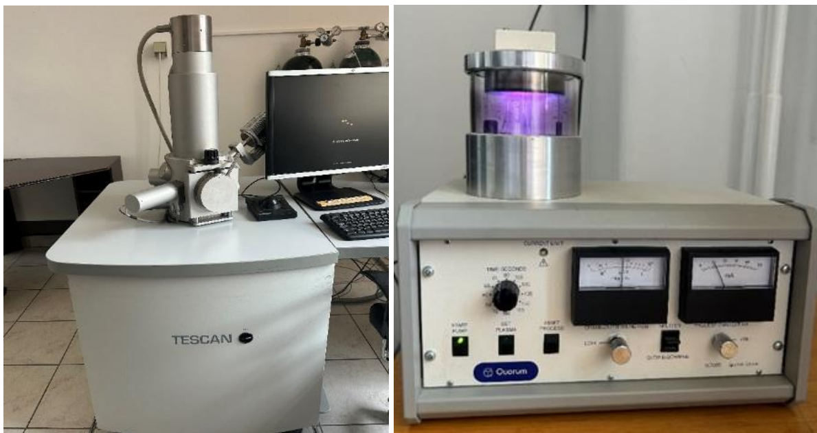
Slika 15. Pretražni elektronski mikroskop VEGA 3 SBH Easy Probe (TESCAN ORSAY HOLDING, Brno, Češka) – lijevo Uređaj za napanje uzoraka SC 7620 (Quorum Technologies, Laughton, United Kingdom) – desno
