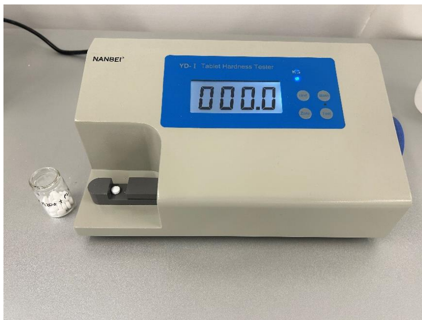
Slika 18. Uređaj YD – 1 Tablet Hardness Tester koji služi za određivanje čvrstoće (Zhengzhou Nanbei Instrument, Henan, NR Kina).
