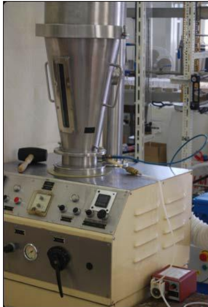
Slika 13. Fotografija granulatora s fluidiziranim slojem Uni-Glatt (Glatt GmbH, Binzen, SR Njemačka).
