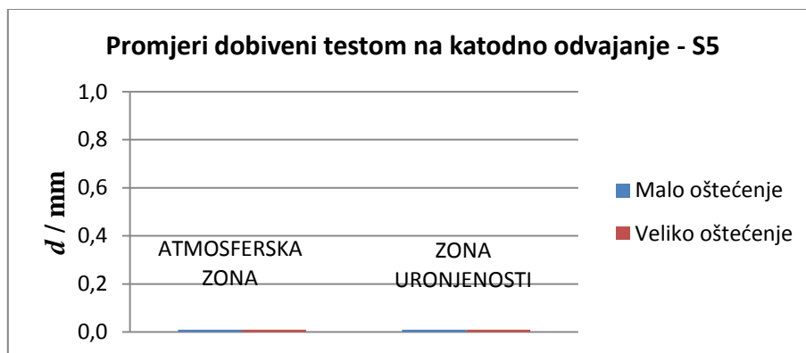
Slika 4.25. Ukupni promjeri inicijalnih oštećenja i odignutih premaza dobiveni testom na katodno odvajanje za malo i veliko oštećenje u atmosferskoj zoni i zoni uronjenosti za sustav S5
