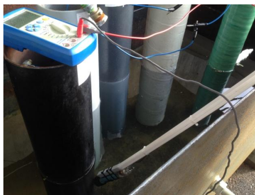
Slika 3.9. Mjerenje potencijala sustava pomoću Zn elektrode
