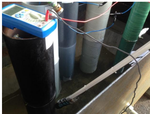
Slika 3.9. Mjerenje potencijala sustava pomoću Zn elektrode
