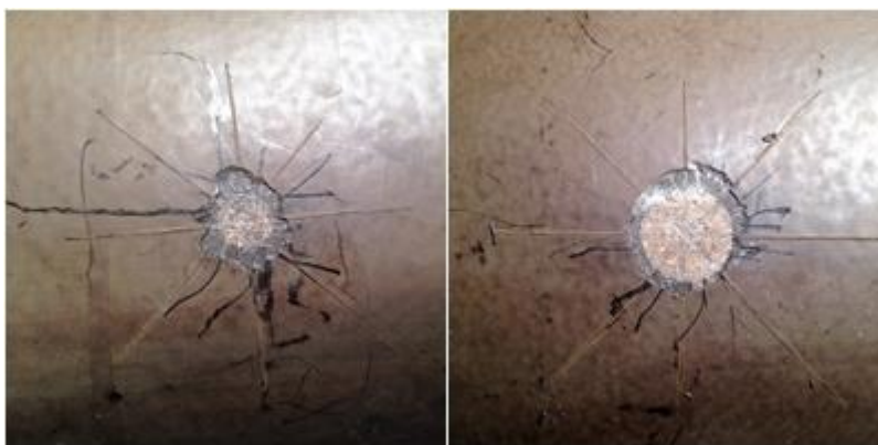
Slika 4.12. Test na katodno odvajanje oštećenja promjera 6,5 mm i 13 mm za sustav S1 u atmosferskoj zoni
