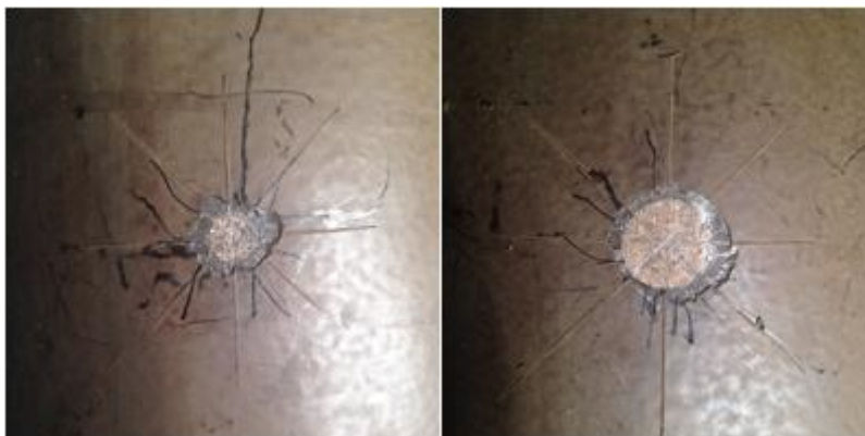
Slika 4.11. Test na katodno odvajanje oštećenja promjera 6,5 mm i 13 mm za sustav S1 u zoni uronjenosti
