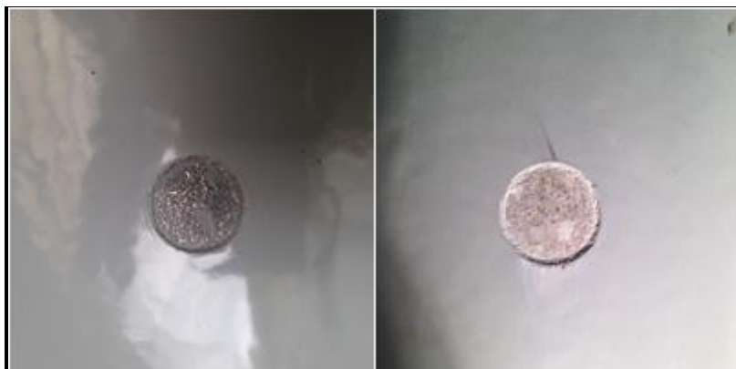
Slika 4.4. Izgled oštećenja sustava S2 promjera 13 mm prije i nakon izlaganja NaCl – u
