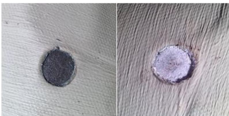
Slika 4.8. Izgled oštećenja sustava S4 promjera 13 mm prije i nakon izlaganja NaCl – u
