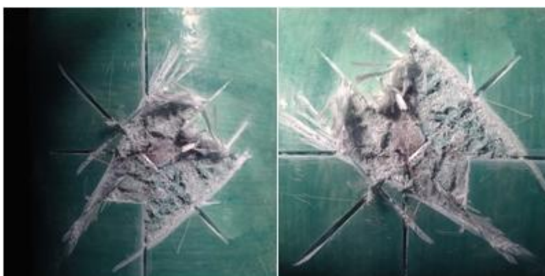
Slika 4.24. Test na katodno odvajanje oštećenja promjera 6,5 mm i 13 mm za sustav S5 u atmosferskoj zoni
