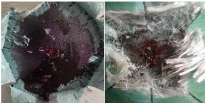
Slika 4.26. Izgled površina oštećenja sustava S4 i S5 nakon ispitivanja pH vrijednosti fenolftaleinom
