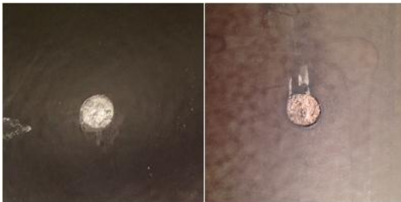
Slika 4.1. Izgled oštećenja sustava S1 promjera 6,5 mm prije i nakon izlaganja NaCl – u
