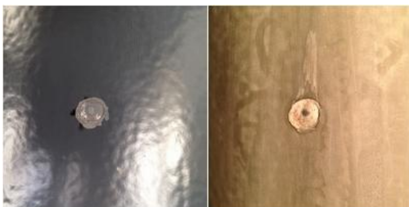
Slika 4.5. Izgled oštećenja sustava S3 promjera 6,5 mm prije i nakon izlaganja NaCl – u
