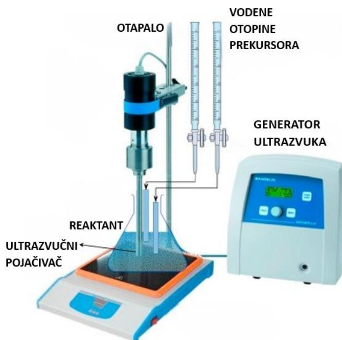
SLIKA 4. Prikaz aparature za sintezu visoko-entropijskih oksida sutaloženjem [7]
