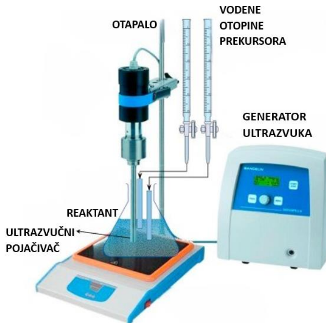
SLIKA 4. Prikaz aparature za sintezu visoko-entropijskih oksida sutaloženjem [7]
