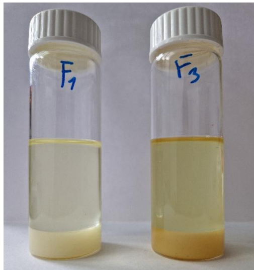
Slika 18. Pripremljeni pseudotrokomponentni sustav voda – glicerol – FABE. Lijevo FABE 1, desno FABE 2. Talog u donjem sloju.
