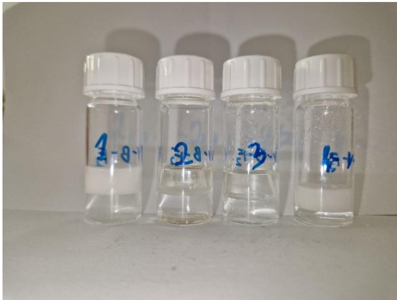
Slika 12. Pseudotrokomponentni sustavi voda – butanol – FABE 2
