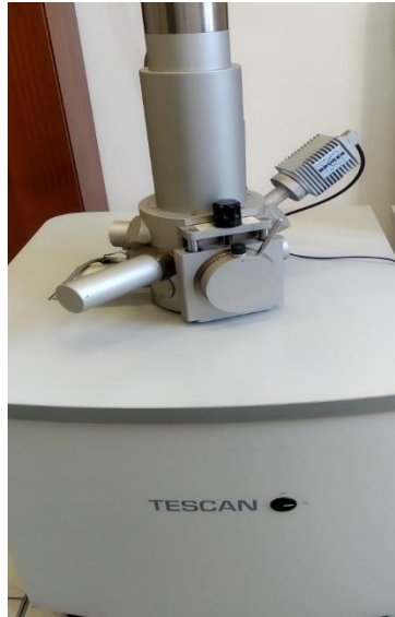
Slika 8. Pretražni elektronski mikroskop
