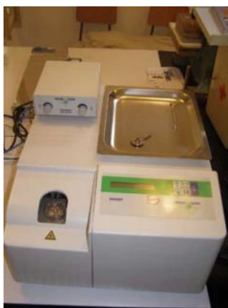
Slika 12. Uređaj za DSC analizu [18]
