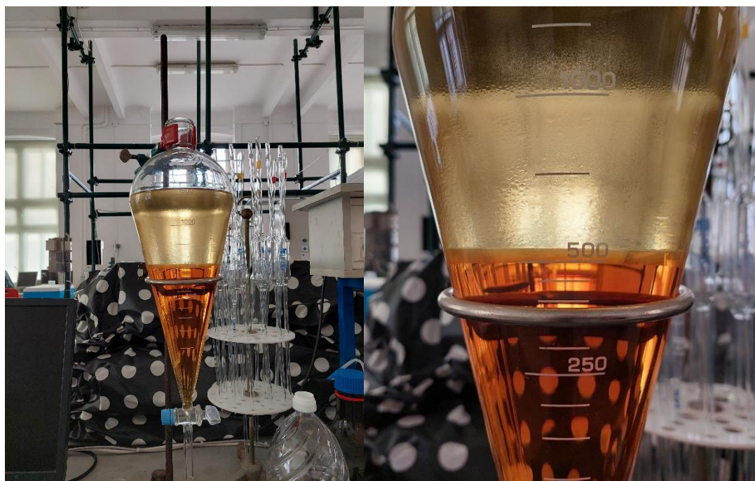
Slika 12. Lijevak za odjeljivanje u kojem se provodi razdvajanje biodizela i glicerola
