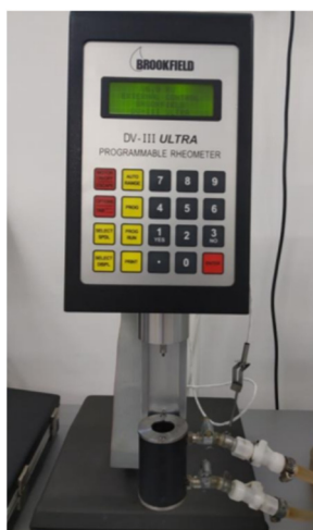
Slika 5. Reometar Brookfield DV-111 ULTRA .
