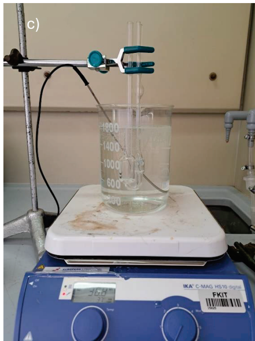
Slika 11. Prikaz aparature korištene u eksperimentu: a) odmjerne tikvice za pripremanje otopina, b) predgrijavanje tikvica prije mjerenja i c) Ubbelohde viskozimetar u vodenoj kupelji
