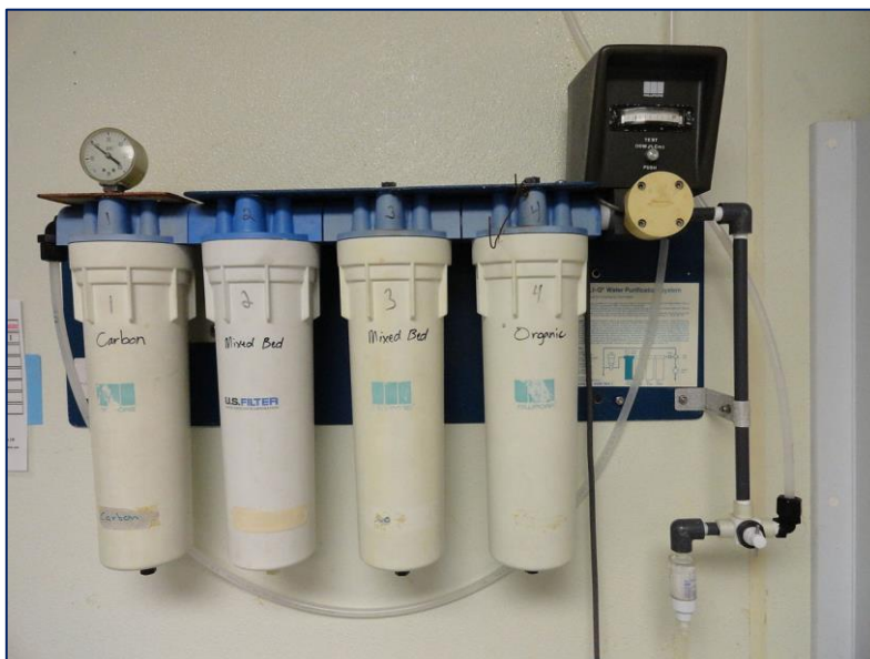
Slika 10. Korištena aparatura za dobivanje ultračiste vode.
