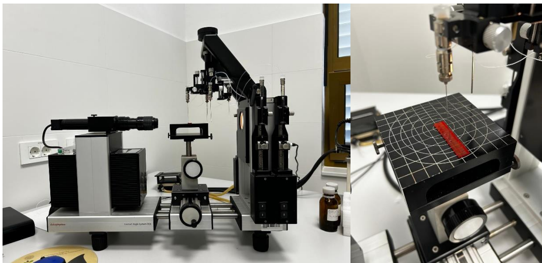
Slika 29. Mjerenje kontaktnog kuta na goniometru OCA 20 DataPhysics
