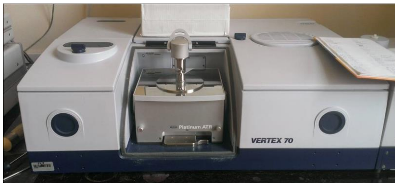
Slika 3.5. FTIR spektrometar Vertex 70 s platinastim detektorom
