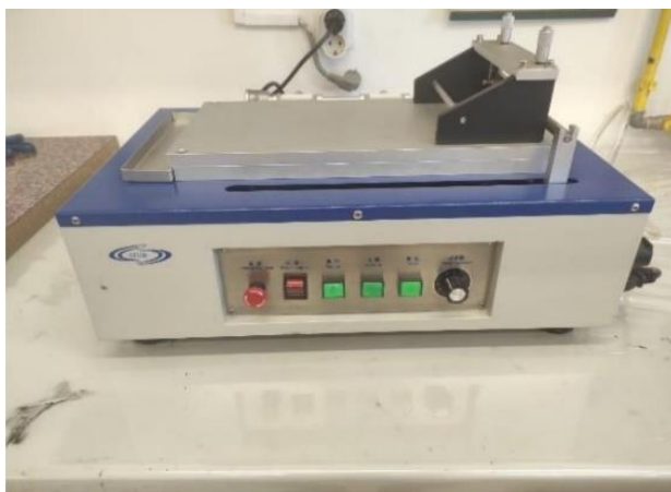
Slika 3.1. Uređaj za nanošenje sloja Doctor blade
