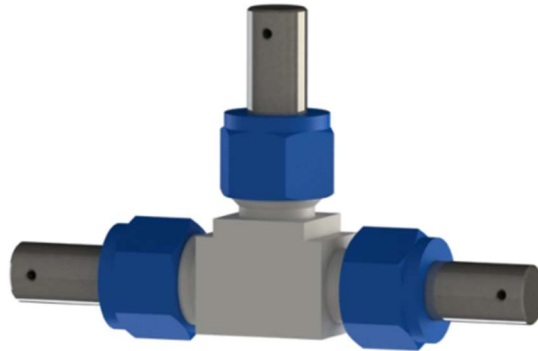
Slika 3.2. Troelektrodna Swagelok ćelija od PFA
