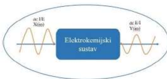
Slika 2.7. Shematski prikaz mjerenja EIS
