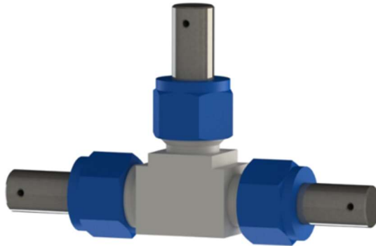
Slika 3.2. Troelektrodna Swagelok ćelija od PFA
