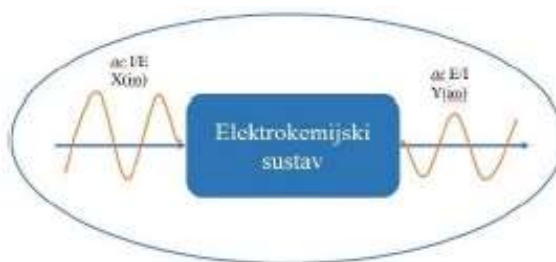
Slika 2.7. Shematski prikaz mjerenja EIS
