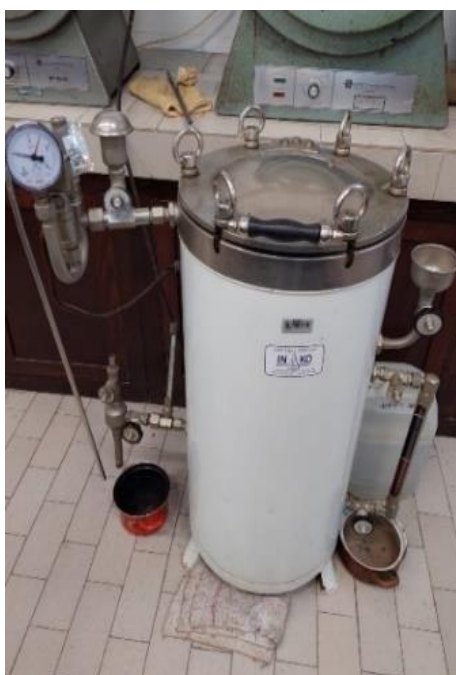
Slika 17. Prikaz autoklava korištenog za provedbu vlažne sterilizacije.
