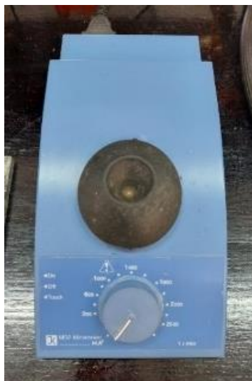
Slika 18. Homogenizator IKA M52 upotrebljavan prilikom pripreme decimalnih razrjeđenja.
