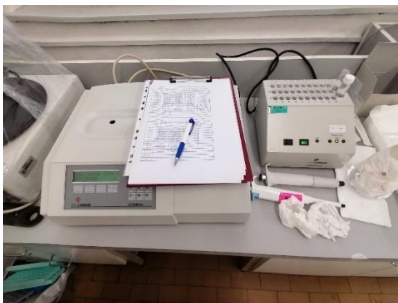
Slika 19. Luminometar i termostat korišteni prilikom provedbe testova toksičnosti primjenom Vibrio fischeri .
