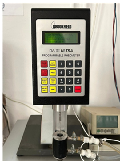
Slika 3.3. Viskozimetar Brookfield DV-111 ULTRA .
