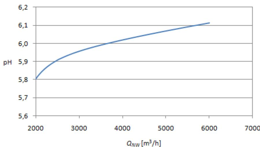
Slika 4.16. Ovisnost  $pH$  efluenta o protoku vode za neutralizaciju ( $Q_{NW}$ ) sastava  $A_T = 2800 \mu\text{mol/L}$  i  $S = 40 \text{ ppt}$
