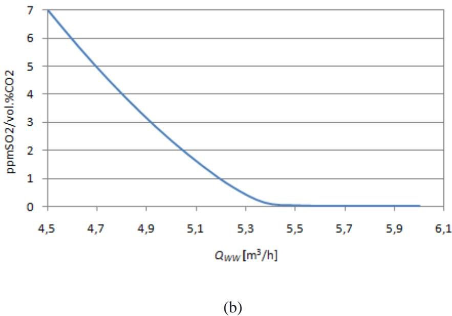
Slika 4.9. Ovisnost omjera volumnog udjela SO<sub>2</sub> u ppm i volumnog postotka CO<sub>2</sub> u pročišćenom plinu o protoku vode za pranje ( $Q_{WW}$ ) sastava  $A_T = 2300 \mu\text{mol/L}$  i  $S = 35 \text{ ppt}$
