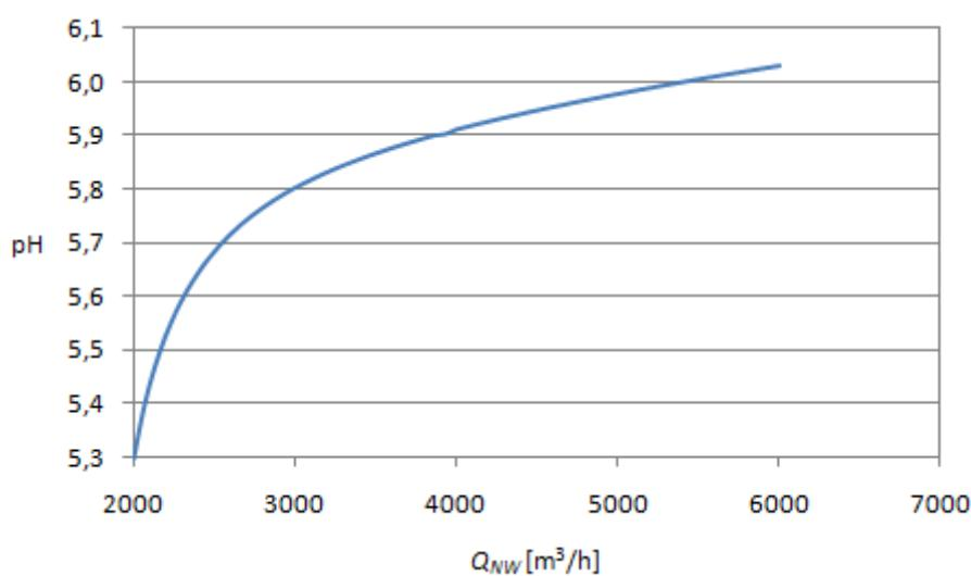
Slika 4.18. Ovisnost  $pH$  efluenta o protoku vode za neutralizaciju ( $Q_{NW}$ ) sastava  $A_T = 2300 \mu\text{mol/L}$  i  $S = 35 \text{ ppt}$
