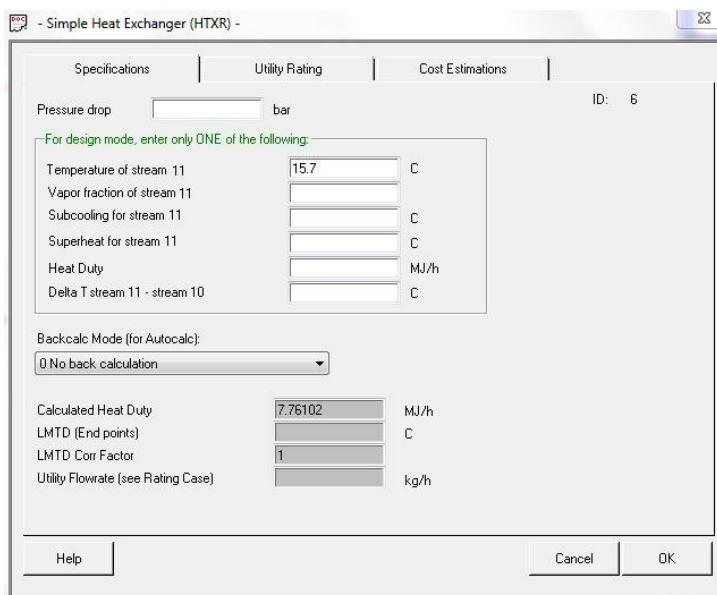
Slika 3.5. Izbornik za specifikaciju izmjenjivača topline
