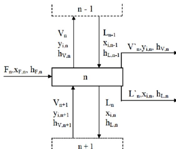
Slika 2.4. Teorijska pojna plitica s varijablama za razvijanje *MESH* jednadžbi<sup>23</sup>
