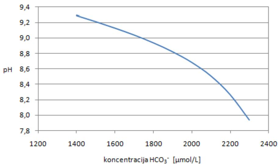
Slika 4.2. Ovisnost vrijednosti pH o koncentraciji HCO<sub>3</sub><sup>-</sup> μmol/L
