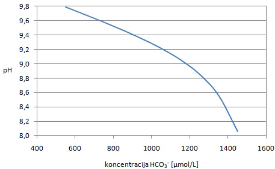
Slika 4.4. Ovisnost vrijednosti  $pH$  o koncentraciji  $\text{HCO}_3^-$ ,  $\mu\text{mol/L}$
