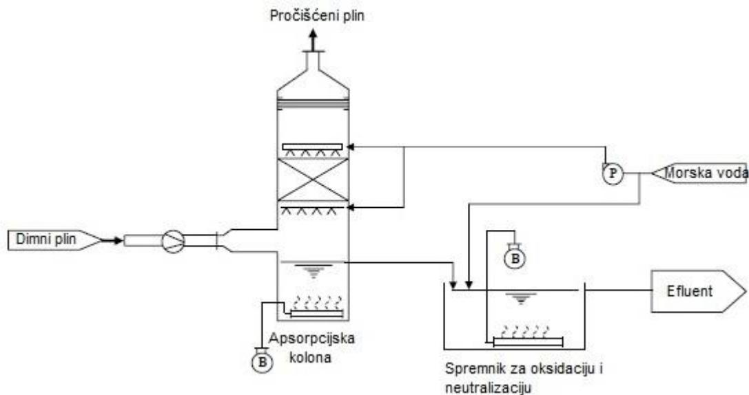
Slika 2.2. Pojednostavljena shema apsorpcije  $SO_2$  morskom vodom
