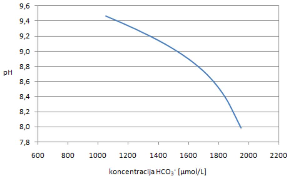
Slika 4.3. Ovisnost vrijednosti  $pH$  o koncentraciji  $\text{HCO}_3^-$ ,  $\mu\text{mol}/\text{L}$
