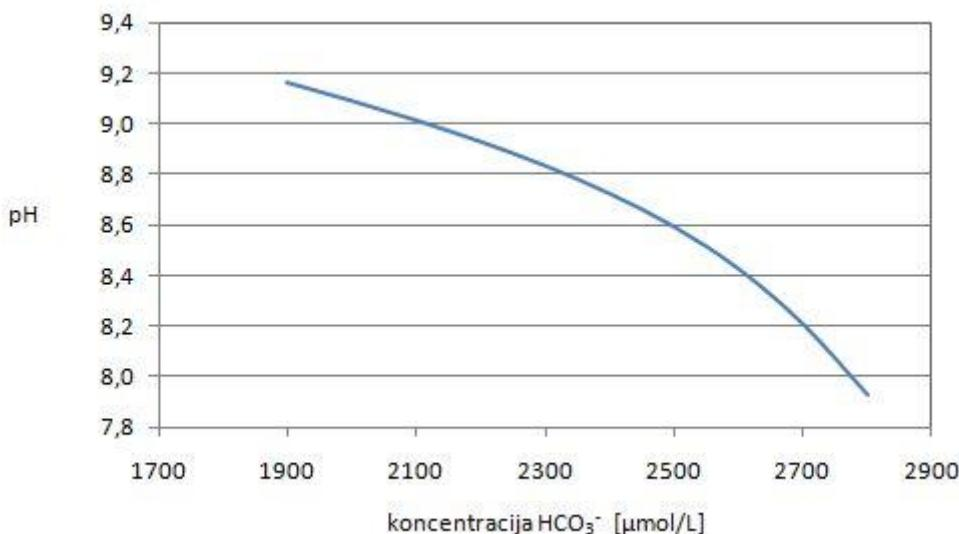
Slika 4.1. Ovisnost vrijednosti  $pH$  o koncentraciji  $\text{HCO}_3^-$ ,  $\mu\text{mol/L}$
