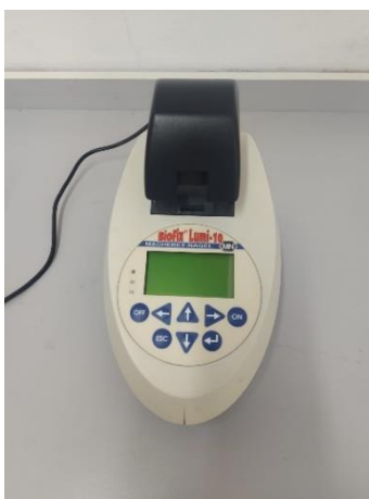
Slika 17. BioFix Lumi – 10, Luminometar, Macherey – Nagel, Velika Britanija.
