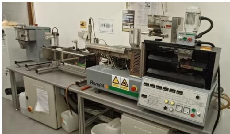
Slika 13. Laboratorijski dvopužni ekstruder RONDOL BenchTop.
