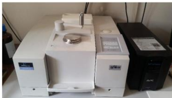
Slika 14. Spektrofotometar FT-IR Spectrum One, Perkin Elmer, SAD.
