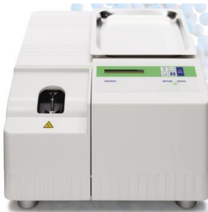
Slika 16. Diferencijalni pretražni kalorimetar, Mettler Toledo DSC 823Et.
