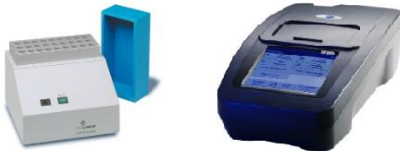
Slika 20. LT20 BOD5 termostat, Hach Lange, Njemačka (lijevo); DR2800 spektrofotometar, Hach Lange, Njemačka (desno).[33]
