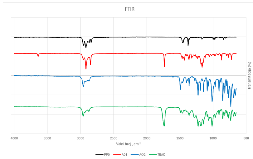
Slika 21. FTIR spektri polipropilena (PP0), korištenih antioksidansa (AO1 i AO2) i plastifikatora (ATBC)
