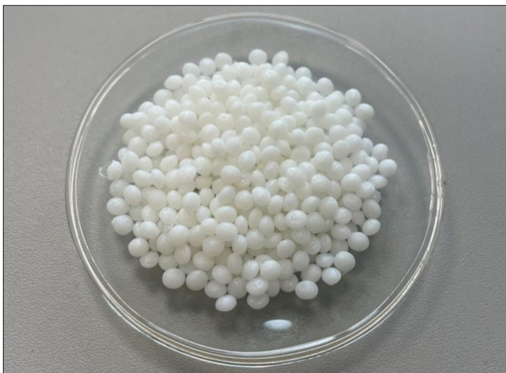
Slika 13. Granule polikaprolaktona (PCL) korištenog za izradu kompozita
