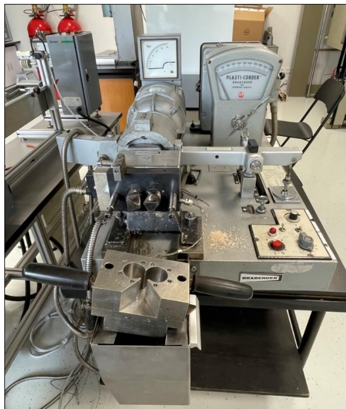
Slika 15. Brabender gnjetilica korištena za izradu kompozita
