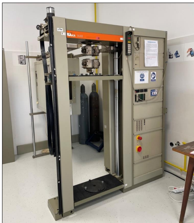
Slika 25. Mehanička kidalica Zwick 1445
