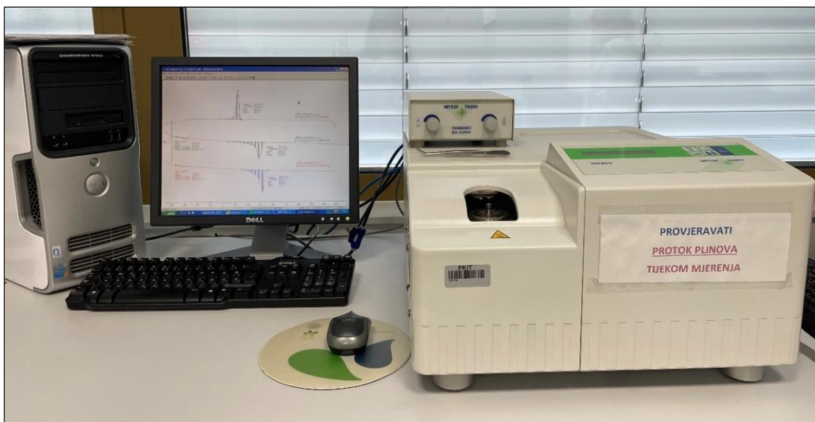
Slika 20. DSC uređaj Mettler Toledo DSC823e
