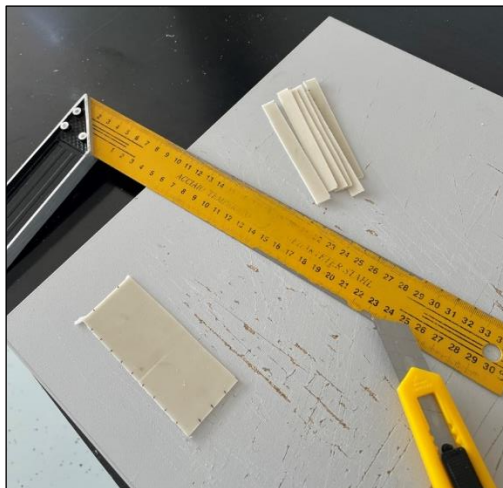
Slika 19. Rezanje epruveta dimenzija 10 × 100 mm, debljine 1 mm
