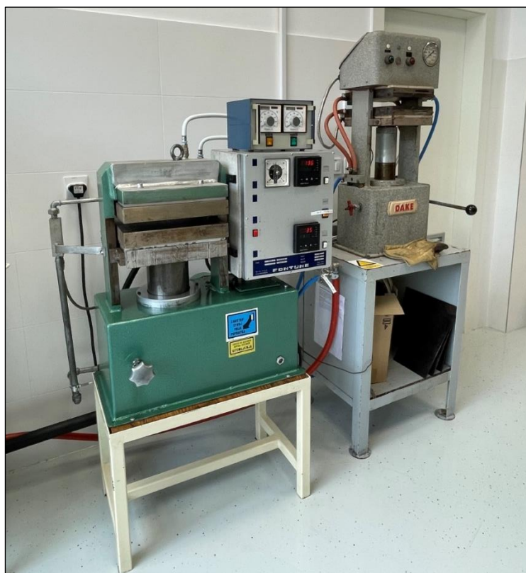
Slika 18. Laboratorijska hidraulička preša za vruće prešanje Fontune, Holland (lijevo) i hidraulička preša za hladno prešanje Dake Model 44-226 (desno)
