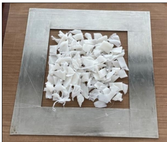
Slika 17. Priprema uzorka za prešanje
