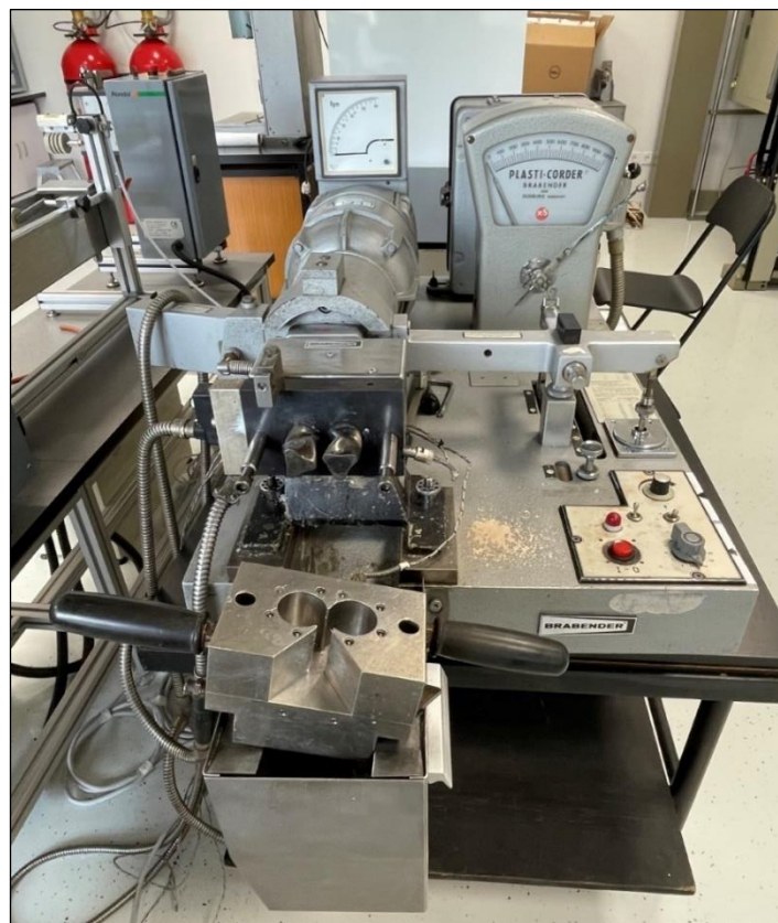
Slika 15. Brabender gnjetilica korištena za izradu kompozita
