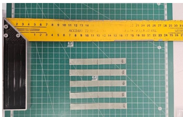
Slika 18. Priprema ispitnih tijela za određivanje mehaničkih svojstava
