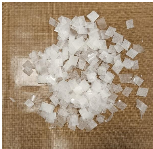
Slika 16. TPS film narezan i pripremljen za prešanje
