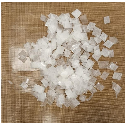
Slika 16. TPS film narezan i pripremljen za prešanje
