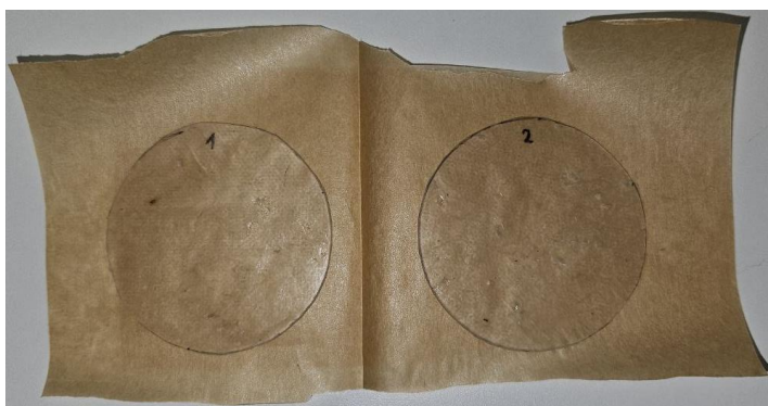
Slika 19. Priprema uzoraka za ispitivanje propusnosti vodene pare
