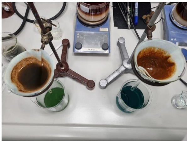
Slika 3.7. Filtracija reakcijske smjese
