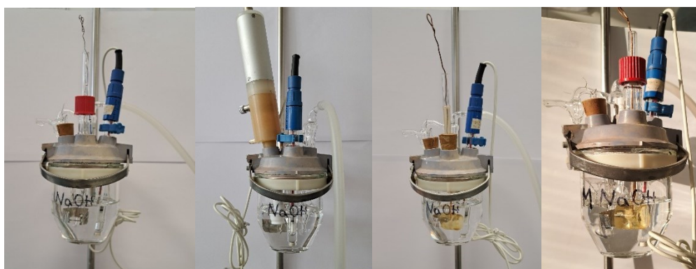
Slika 13. Elektrolizer s različitim radnim elektrodama, s lijeva na desno, Pt pločica, Pt RDE, Ni, CoCrMo
