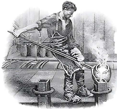
Slika 2: Lijevanje čelika dobivenog Huntsmanovom metodom 10
