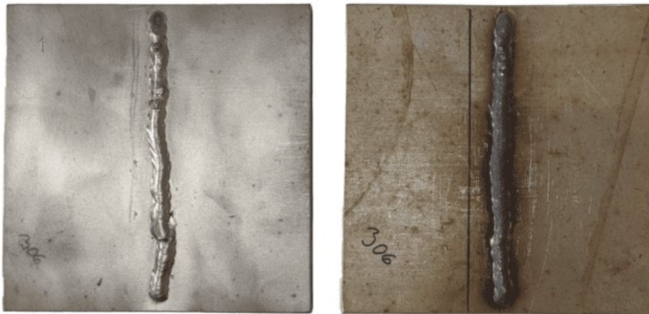
Slika 20: Fotografija uzorka 1 (lijevo; mehanički očišćen) i uzorka 2 (desno; mehanički neočišćen)
