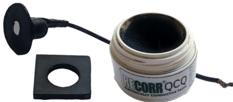
Slika 22: Elektrokemijska ćelija s maskom te ReCorr® QCQ elektrolitska pasta
