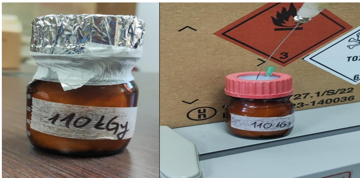
Slika 3.4. Pripremljene elektrode za zračenje (lijevo) i propuhivanje elektroda argonom (desno).
