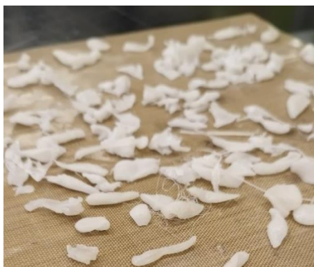
Slika 12. Narezani uzorci nakon zamiješavanja u Brabender gnjetilici
