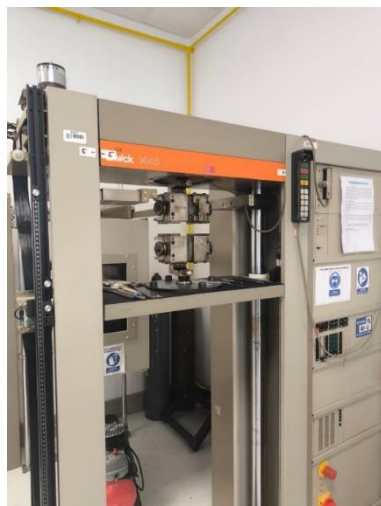
Slika 18. Univerzalna mehanička kidalica Zwick 1445
