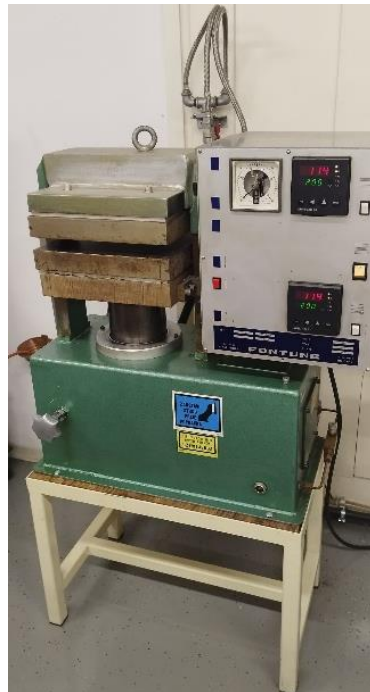
Slika 13. Priprava a) pločica u kalupu b) Hidraulička preša Fontune Holland i c) gotova pločica
