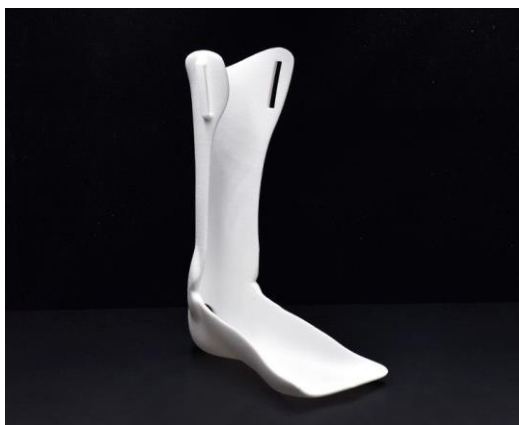
Slika 7. Primjeri 3D ispisa funkcionalnih dijelova tijela iz poliamida PA12 [16]
