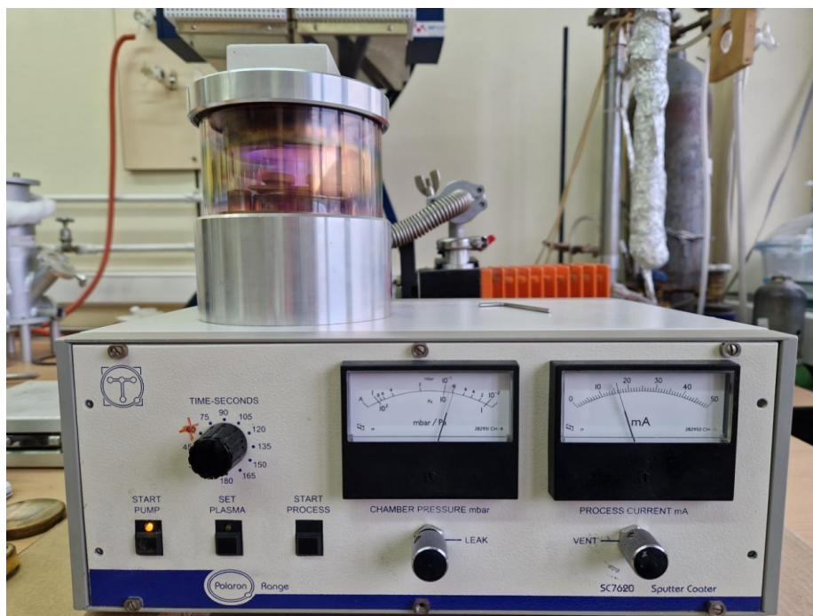
Slika 18. Uređaj za nanošenje zlatnih elektroda Sputter coater SC7620
