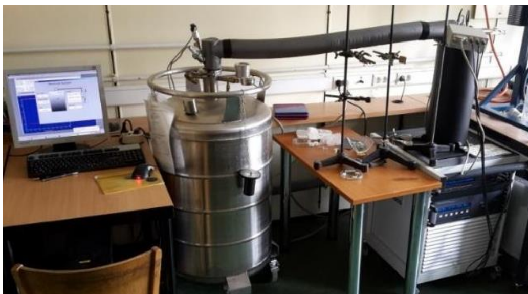
Slika 19. Sustav za impedancijsku spektroskopiju
