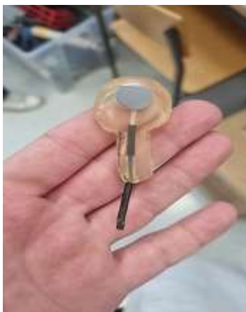
Slika 12. Radna elektroda nehrđajućeg čelika
