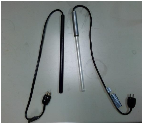
Slika 16. UV lampa koja emitira zračenje pri valnoj duljini od 365 nm (crna) te UV lampa koja emitira pri valnoj duljini od 254/185 nm (bijela)
