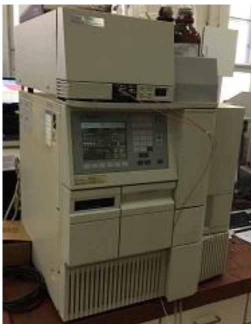
Slika 18. Kromatografski sustav Waters Alliance 2795
