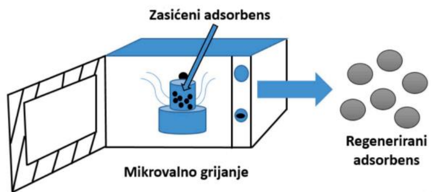
Slika 2.19. Shematski prikaz mikrovalne regeneracije adsorbensa [60]
