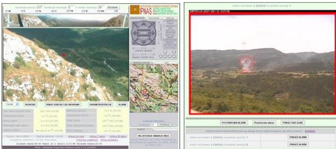
Slika 15. Ekran ručnog rada sustava IPNAS i primjer alarmnog prozora. Kamerom se ručno upravlja preko geo-referenciranih mapa, panoramskih prikaza, virtualnih komandi ili jednostavno klikom na mjesto na slici. U alarmnom prozoru prikazani su svi alarmi posljednjih pola sata. Na operateru je da ih klikom miša potvrdi ili poništi. [95]
