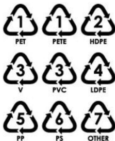
Slika 10. Simboli pojedinih vrsta polimernih materijala [31]
