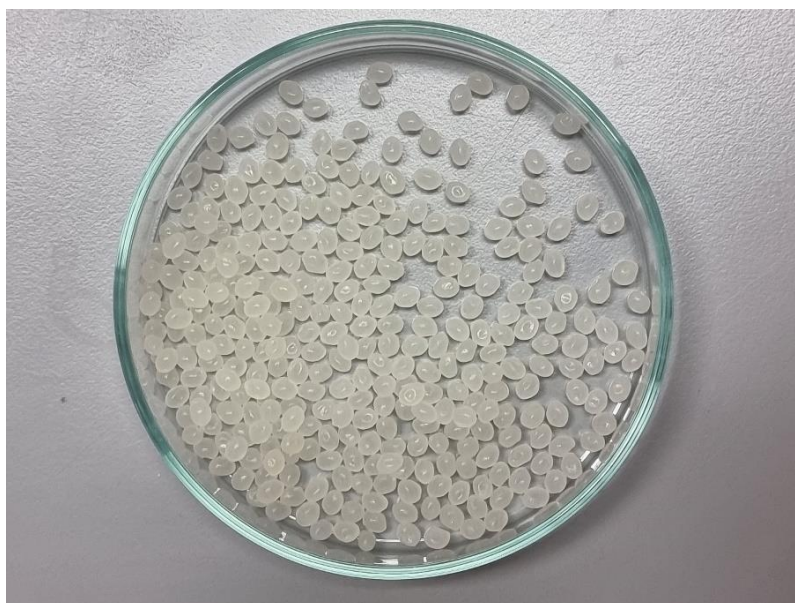
Slika 3.2. PLA tehničke čistoće u obliku perli
