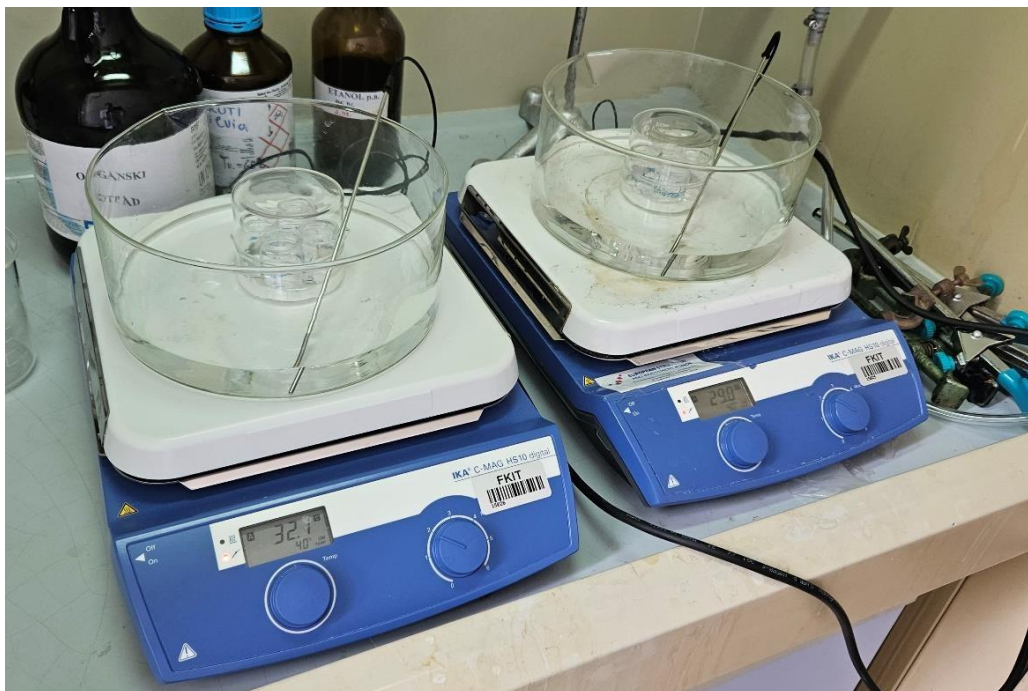
Slika 3.4. Prikaz uzoraka na magnetskoj miješalici s grijačem
