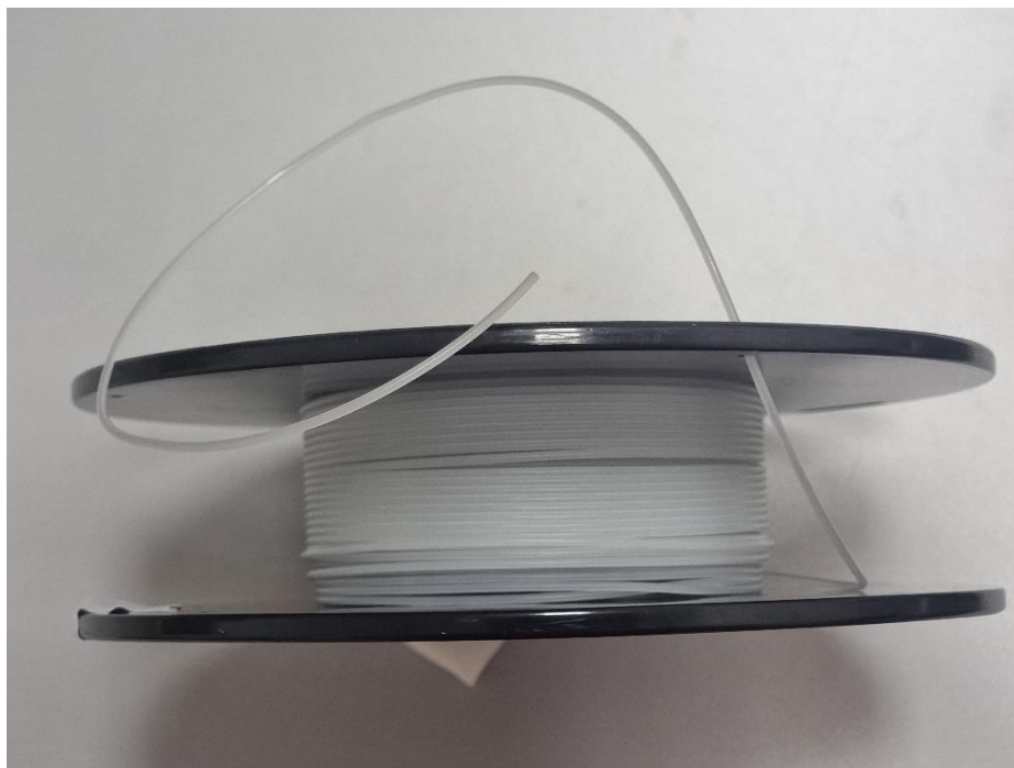
Slika 3.3. PLA medicinske čistoće u obliku filamenta za 3D ispis
