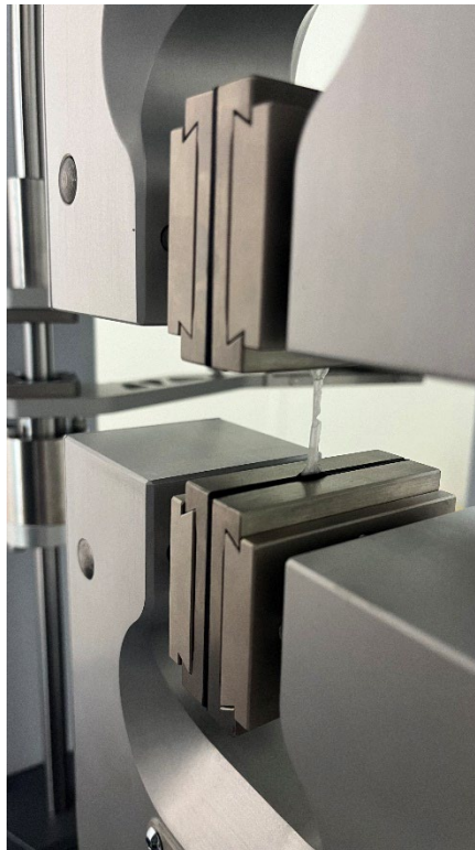
Slika 39. Prikaz puknute epruvete na jednom dijelu vrata
