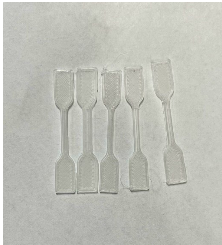
Slika 22. Prikaz 3D-ispisanih epruveta od PVB pod 0° debljine sloja 0,20 mm
